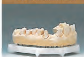
石膏膨脹所造成的空隙
